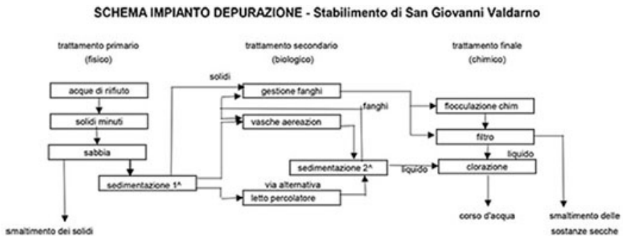
Fig. 71 Processo trattamento Ecologico delle acque reflue
