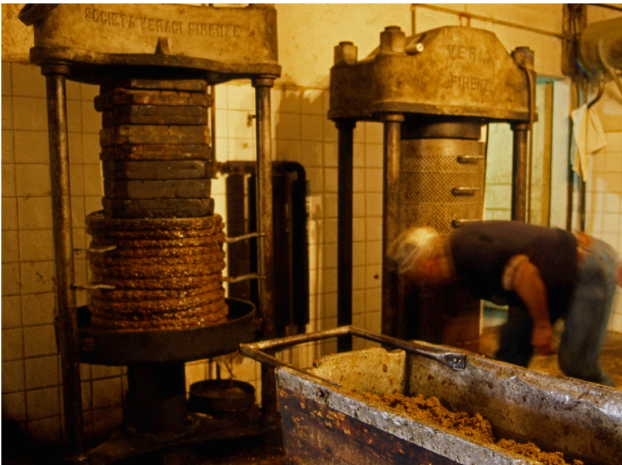
17. La pasta di olive frante, i ficoli con la pasta sotto il torchio
