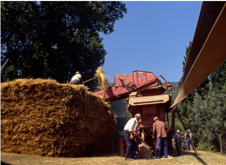
21. Particolare della cinghia di trasmissione
